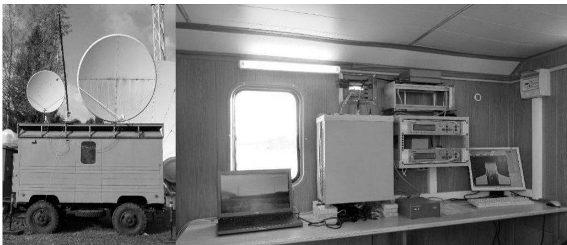
Рис. 1. Широкополосная радиолокационная измерительная установка на базе векторного анализатора цепей
