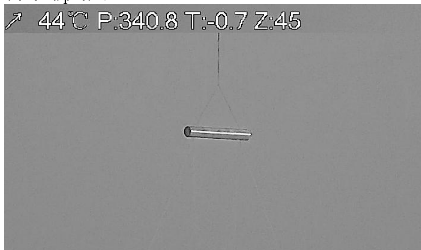
Рис. 4. Объект исследований на подъемно-поворотной системе открытого радиолокационного измерительного полигона
